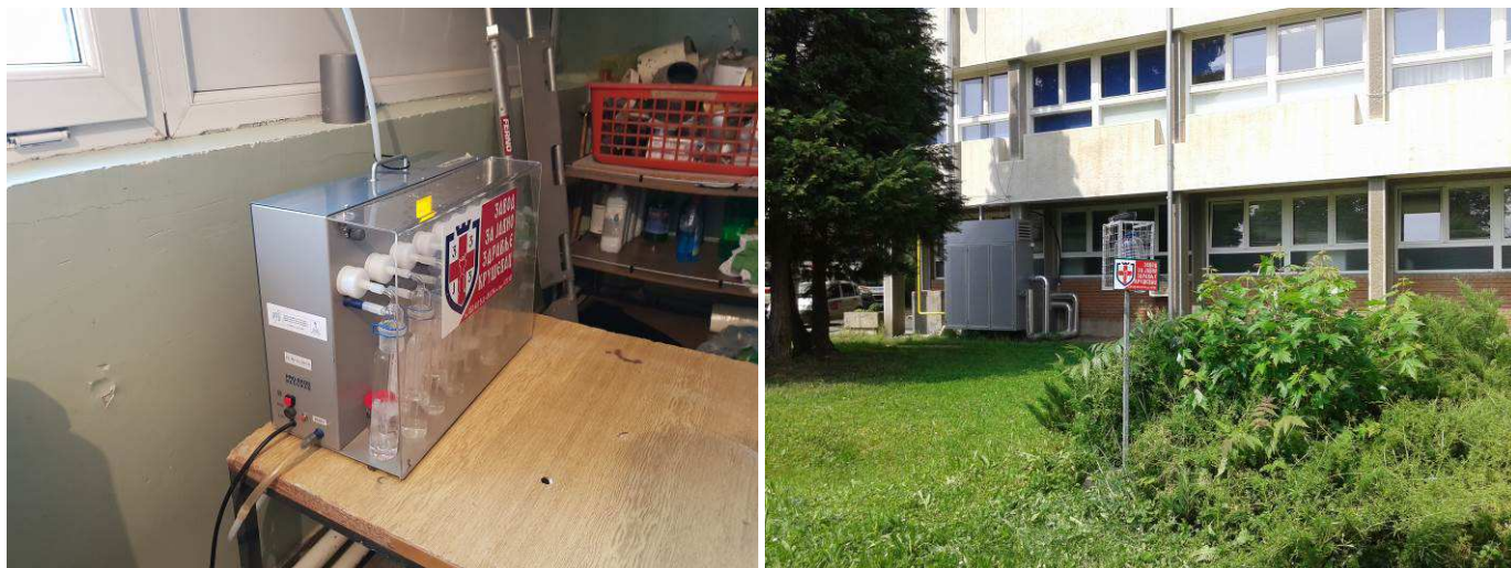
Слике 1 и 2. Мерно место– Трстеник- Хитна помоћ, опрема за узорковање \text{SO}_2 , \text{NO}_2 и чађи (лево), седиментатори (десно)
